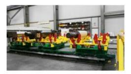
La Linea di Business Industries è operativa nella progettazione e fornitura di attrezzature per laminatoi, necessarie per la rimozione dei cilindri di laminazione. Questi sistemi sono concepiti per sollevare il personale manutentivo da attività gravose e pericolose, al fine di agevolare e rendere sicure determinate operazioni, con la conseguenza di un notevole miglioramento del tasso di produzione.
