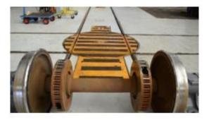
Le piattaforme di rotazione rappresentano il metodo ottimale per il trasferimento rapido e sicuro di carrelli e sale montate all'interno delle officine ferroviarie. Queste piattaforme possono essere progettate specificamente per rotolare carrelli con un peso compreso tra 6 e 25 tonnellate o assi con un peso variabile da 2 a 6 tonnellate. Sono disponibili in diverse configurazioni in termini di diametro e scartamento, in modo da adattarsi alle specifiche esigenze del luogo di installazione.
